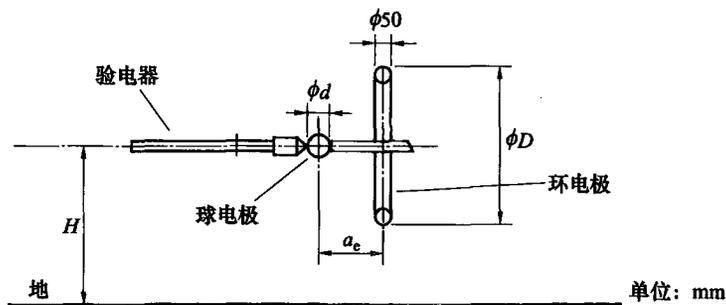
图 4 球电极在环电极之前的试验布置
