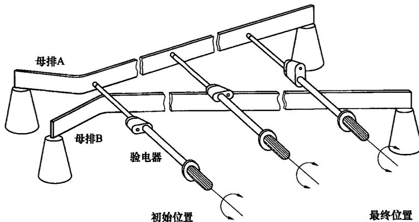
图 20 径向和沿面耐压试验
