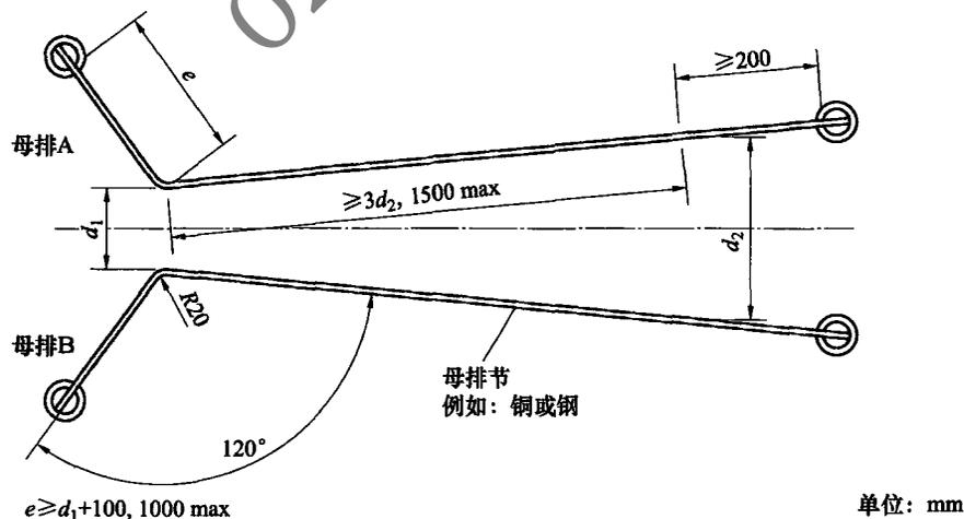
注: 母排截面为  $60\text{mm} \times 10\text{mm}$ , 母排所有边角均为半径  $1\text{mm}$  的圆角。
